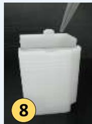
將 1 ml 樣品注入每個細胞卡匣後，請搖動卡匣使其混合均勻。
