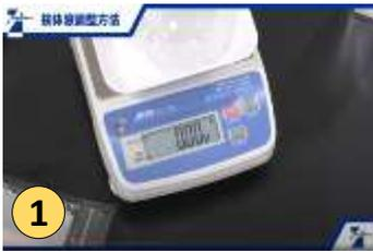
將樣品袋從底部翻起，並立在電子天平上。將樣品袋放在天平上後，將天平歸零。
